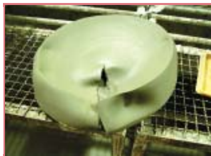
生坯陰乾時的場陷、龜裂狀況
